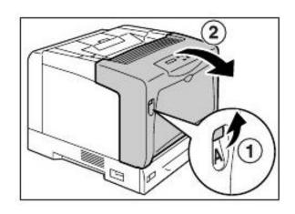
STEP 2:按圖中顯示的橘色按鈕,打開輸出承接盤外蓋。
